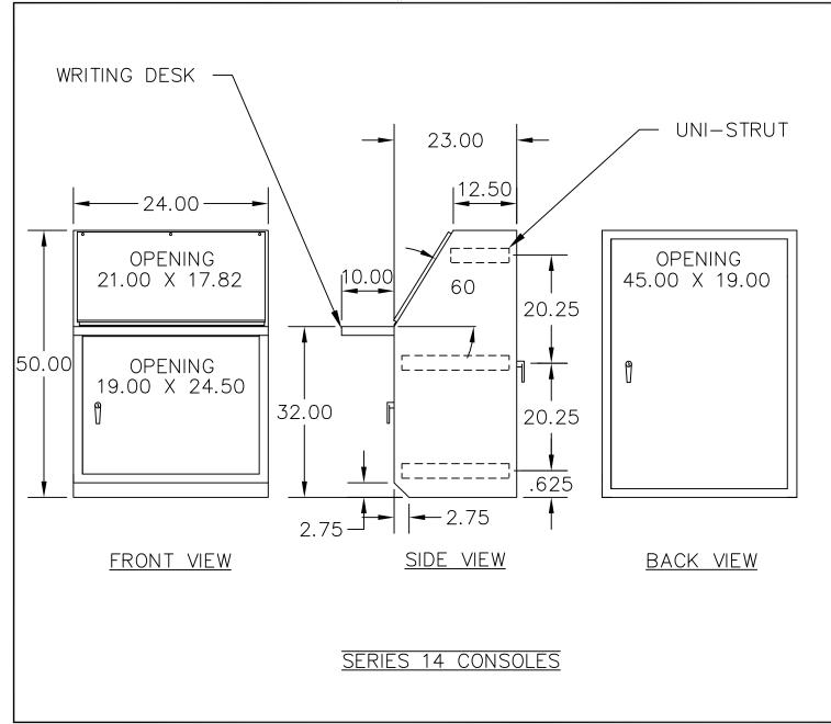
CONSTRUCTION: -14 GAUGE PAINT GRIP GALVANIZED STEEL. -SEAMS CONTINUOUSLY WELDED AND GROUND SMOOTH. -SINGLE DOORS ON FRONT AND REAR OF SINGLE DOOR CONSOLES. -FLUSH DOOR SURFACES GIVE SMOOTH APPEAR-ANCE. -3-POINT LATCH OPER-ATED BY KEY LOCKING HANDIF. -ONE SLOPING CONTROL PANELS HINGED ALONG
