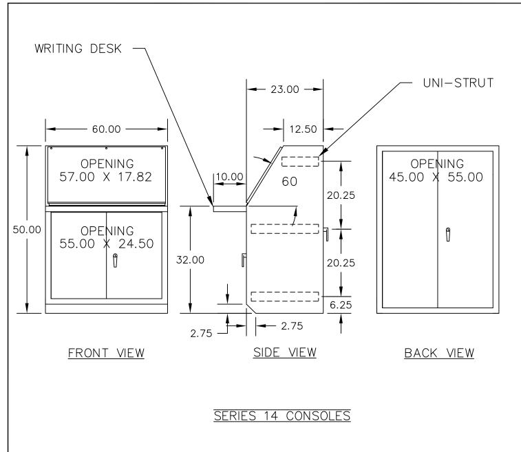
CONSTRUCTION: -14 GAUGE PAINT GRIP GALVANIZED STEEL. -SEAMS CONTINUOUSLY WELDED AND GROUND SMOOTH. -DOUBLE DOORS ON FRONT AND REAR. -FLUSH DOOR SURFACES GIVE SMOOTH APPEAR-ANCE. -3-POINT LATCH OPER-ATED BY KEY LOCKING HANDLE. -ONE SLOPING CONTROL PANELS HINGED ALONG
